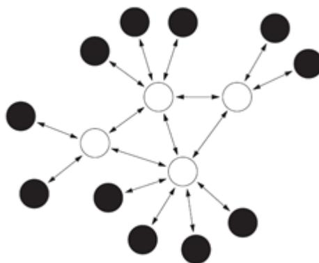
**Figura 3-4.:** Representación esquemática de la topología híbrida estrella - malla.
