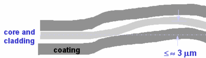
Figura 1. Microcurvaturas, la desviación es inferior a un par de micrones
