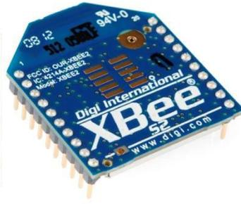
Fig.9. Módulo de transmisión inalámbrica Xbee
