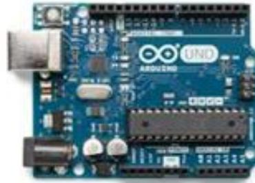
Figura 7.1: Placa Arduino Uno
